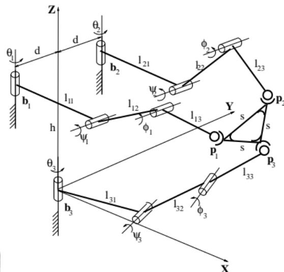
(d) Model of a three-fingered hand
